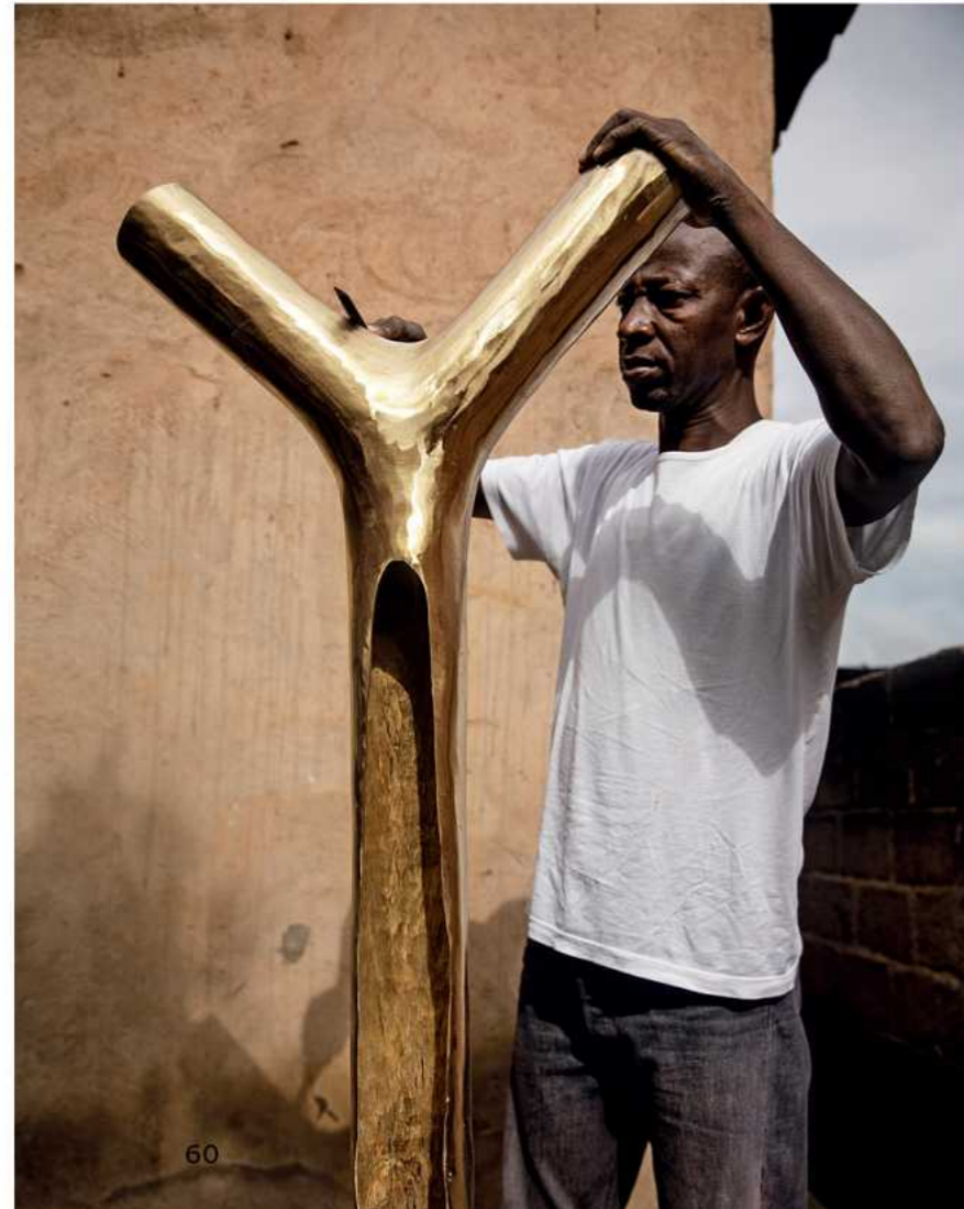
Ein Kunsthandwerker in Ouagadougou poliert li , die totemartige „Y Lamp“ von Noé Duchaufour-Lawrance. Alle Bronzen von Maison Intègre werden im Wachs-ausschmelzverfahren gegossen ( u. ), was bedeutet, sie sind sämtlich Unikate.
