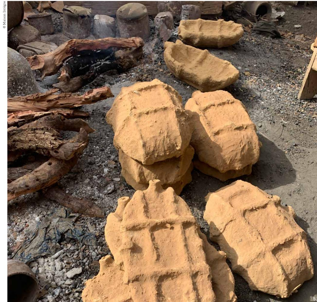
5 — Une fois les moules séchés, on prépare le feu pour extraire la cire /Once the moulds are dried, the fire is prepared to extract the wax
