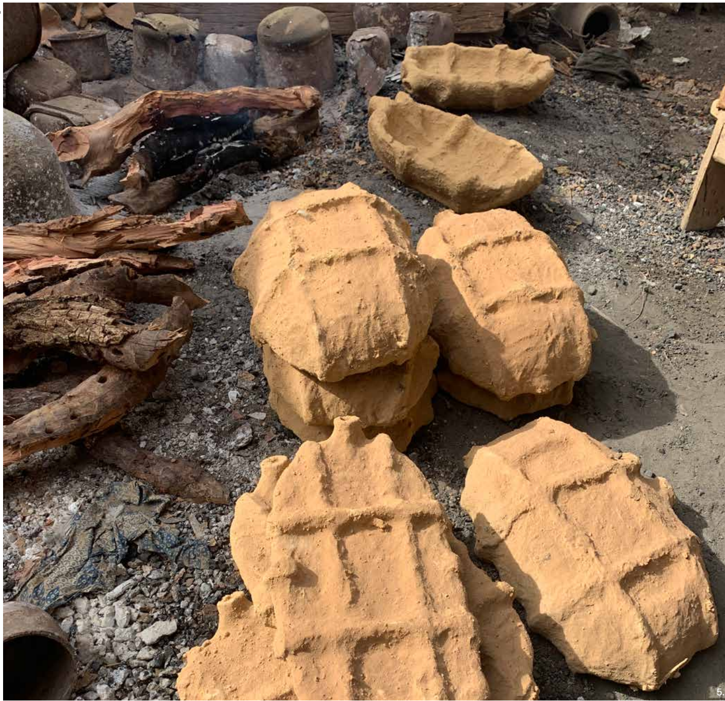
5 — Une fois les moules séchés, on prépare le feu pour extraire la cire /Once the moulds are dried, the fire is prepared to extract the wax 6 — Le bronze est fabriqué à partir de métaux recyclés tels que des robinets, des vis et des boulons. Ils sont chauffés à environ 1200 °C dans un creuset creusé dans le sol. Lorsque la fusion se produit, le bronze est coulé dans le moule en argile /Bronze is made from recycled metals such as taps, screws and bolts. They are heated to about 1200 °C in a melting pot dug into the ground. When the fusion occurs, the bronze is poured in the clay mould 7 — Briser le moule et découvrir le résultat /Breaking the mould and discovering the result
